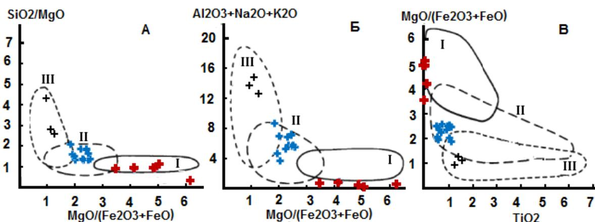
Рисунок 6 – Диаграммы  $\text{SiO}_2/\text{MgO}$ – $\text{MgO}/\text{Fe}_2\text{O}_3$  (А),  $(\text{Al}_2\text{O}_3 + \text{Na}_2\text{O} + \text{K}_2\text{O})$ – $\text{MgO}/\text{Fe}_2\text{O}_3$  (Б) и  $\text{MgO}/\text{Fe}_2\text{O}_3$ – $\text{TiO}_2$  (В) для апопикритовых серпентинитов (красный крест), пикритов (синий крест) и пикритовых диабазов (черный крест) каратургайского комплекса.
