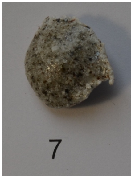
Рисунок 1 – Фотоиллюстрация (7) продукта обжига образца К-1-15 (гранит Кордайского месторождения); температурно-хронологические параметры обжига каменного материала в условиях высокотемпературного нагревания – 1300°С (5', 40', 30')
