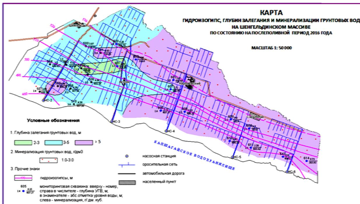
Рисунок 5 – Карта гидроизогипс, глубин залегания и минерализации грунтовых вод на конец вегетационного периода
