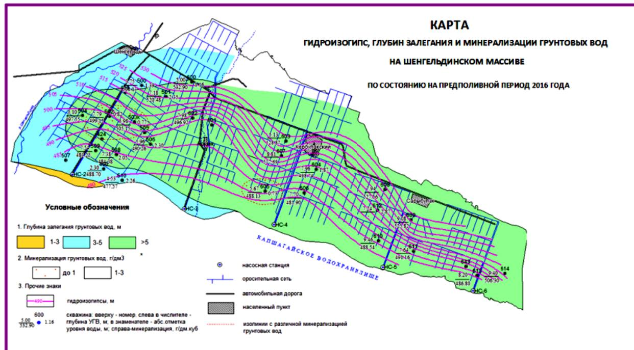
Рисунок 6 – Карта гидроизогиПС, глубин залегания и минерализации грунтовых вод на начало вегетационного периода (май 2016 года)
