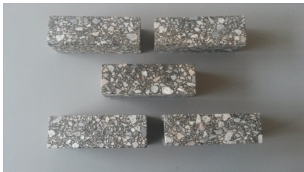
Рисунок 2 – Образцы асфальто- и полимерасфальтобетонов размером 5x5x16 см для испытания
