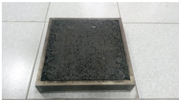
Рисунок 4 – Образец асфальтобетона размером 5x30,5x30,5 см в стальной форме
