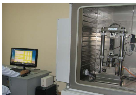
Рисунок 7 – Испытуемый образец асфальтобетона в термокамере прибора TRAVIS
