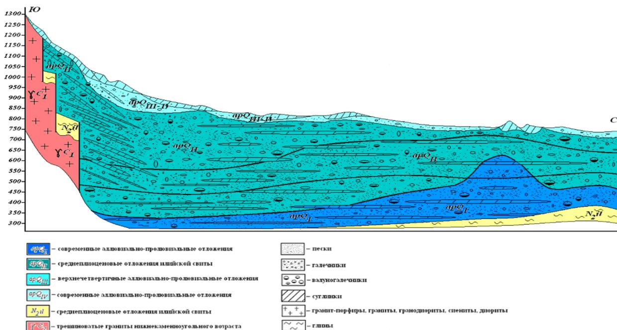
Рисунок 3 – Обобщенный гидрогеологический разрез по профилям I, II и III
