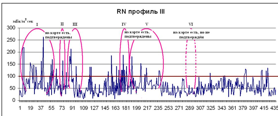
Рисунок 12 – Результаты исследования объемной концентрации почвенного радона Rn<sup>222</sup> по профилю III–III
