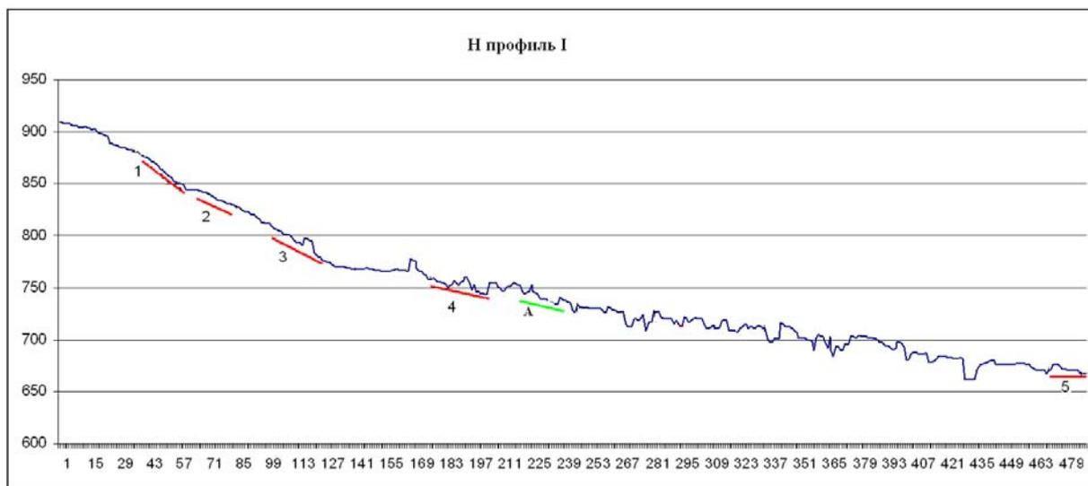
Рисунок 9 – Гипсометрический график профиля I–I с предполагаемыми зонами активных разломов
