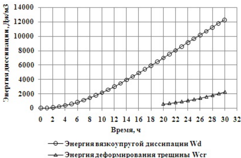
Рисунок 13 – Изменение энергий вязкоупругой диссипации асфальтобетона ( W_d ) и деформирования трещины ( W_{cr} ) Figure 13 – Change in the energy of a viscoelastic dissipation of asphalt concrete ( W_d ) and deformation of the crack ( W_{cr} )
