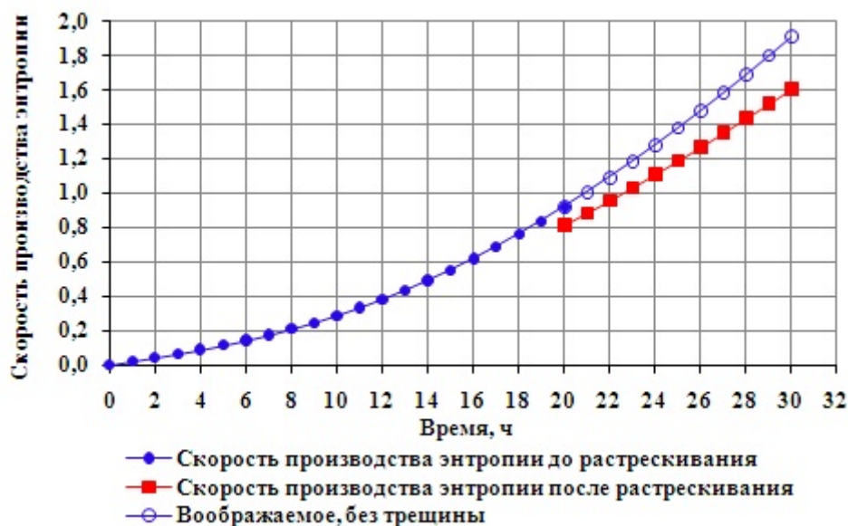
Рисунок 22 – Изменение скорости производства энтропии до и после растрескивания асфальтобетонного покрытия
