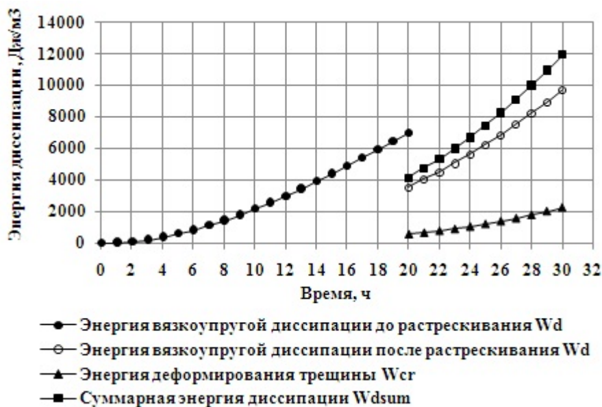
Рисунок 14 – Изменение энергий вязкоупругой диссипации до и после растрескивания покрытия, энергии деформирования трещины и суммарной энергии диссипации
