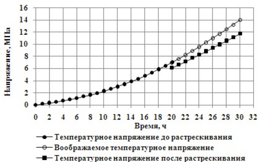
Рисунок 19 – Изменение температурного напряжения в асфальтобетонном покрытии до и после растрескивания
