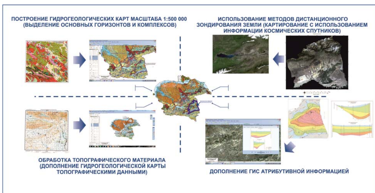
Рисунок 4 – Принцип построения ГИС-системы «Подземные воды Панфиловского района»
