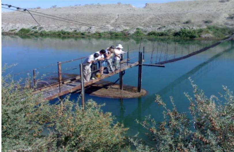
Рисунок 3 – Инструментальный промер глубины реки Каратал с коммерческого гидропоста
